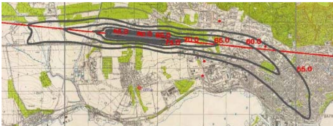
фиг. 3. Шумови контури около летището в LAeq, dB(A), 8 часа, за лятна нощ
